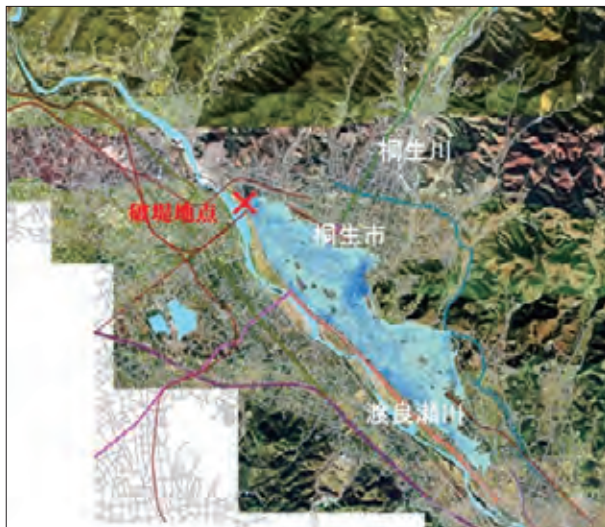
図2 渡良瀬川の氾濫流シミュレーション 桐生市内を貫流する渡良瀬川の氾濫流は扇状地地形に支配されて流下し、大きな流速が市内を襲う
