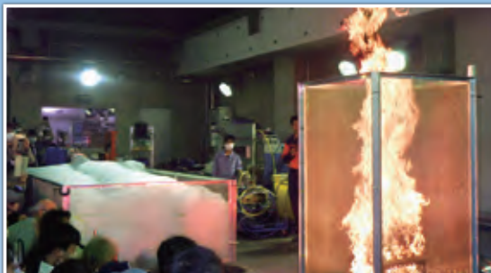
高発砲装置を用いた泡消火実験
