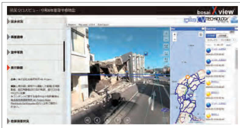
図-3：360°車載カメラによる被災状況把握
